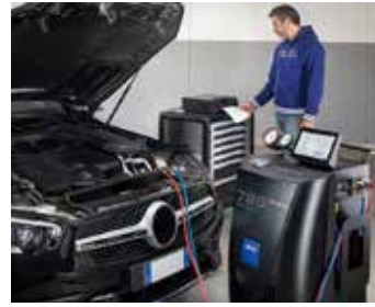
フロンガス交換機
