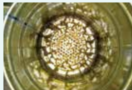
中心部分にもグリスは残らず ほぼプレート内部に取込んだ状態
