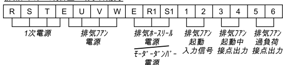
排気システム制御盤 端子台配列
