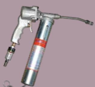
エアコンプレッサーの圧縮空気を接続することで、簡単かつスピーディにグリースアップ作業を行うことができます。機械、車両を始め生産ライン作業に最適です。
