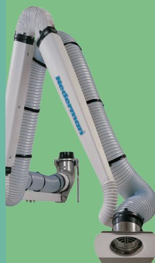
NEXDXアームシリーズは、SUS製のフードと、導電性を持たせたポリウレタン製のホースを持ったホースユニットです。静電気対策が必要な場所での粉塵や溶剤臭気の回収に有効的です。
