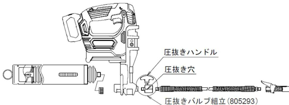
※圧抜きハンドルのみ交換時も必ず 805293 圧抜きバルブ組立として交換願います。
