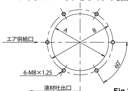
Fig.3 取付寸法
