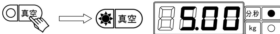
また、時間表示は現在設定されている真空引き時間を表示しています。工場出荷時は 5 分と設定されていますが、1~15 分までの分刻みで設定変更可能です。真空引き時間の設定変更方法は P.15 を参照して 10 分に設定変更してください。
