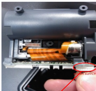
power supply ケーブル
