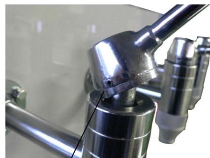
オイルコックをロックした状態
