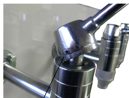
オイルコックをロックした状態
