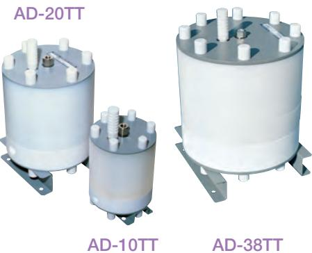
ダイアフラムポンプにより移送される液体の脈動を、圧縮エアを利用して減衰する接液部オールフルッ素樹脂製のバルセーションダンパー（脈動減衰器）です。
