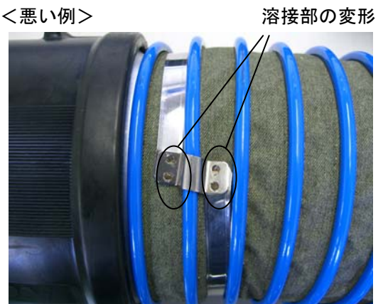
過度の締め付けにより溶接部に大きな変形が見られる状態 Fig. 5 (b)
