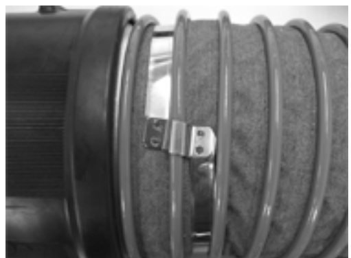
過度の締め付けにより、溶接部に大きな変形が見られる状態 Fig. 8(b)
