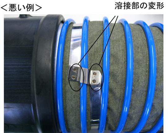
過度の締め付けにより溶接部に大きな変形が見られる状態 Fig.2.21(b)
